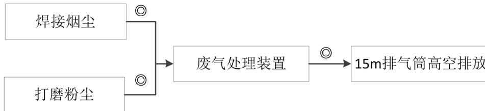
图 3-2 焊接烟尘、打磨粉尘监测点位示意图（◎为监测点位）
